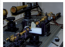
Caractérisation d'une Météorite à 100 GHz
